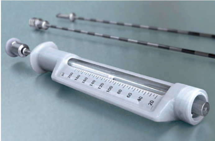
Hochpräzise 200-µl-Spritze zur intrazerebralen Injektion mit Zylinder aus kalibriertem Glasrohr, Kunststoffmantel mit Luer-Lock-Gewinde, Skala und Schutzfunktion sowie Kolbenstange aus Metall mit PTFE-Stopfen, kein Silikonöl.
